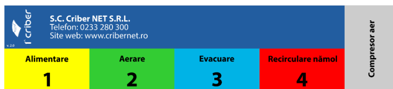
Fig. 3 Eticheta bloc electrovalve - culorile și numerotarea fiecărei etape de funcționare
