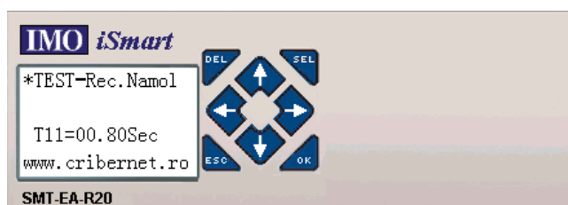
Fig. 5 Testul de recirculare nămol
